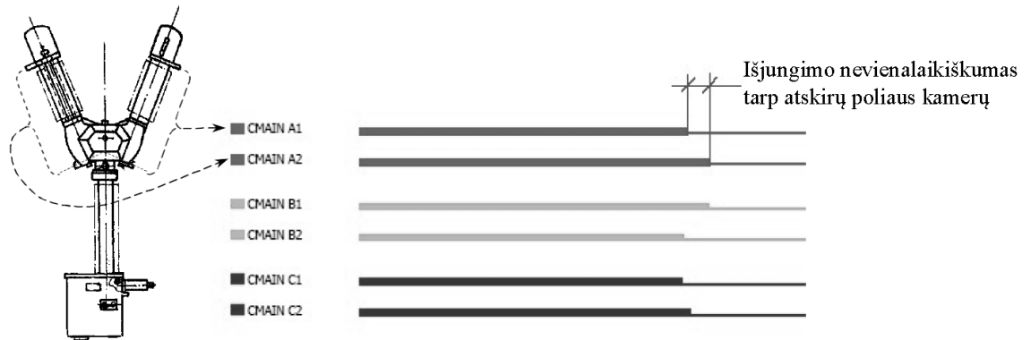
47 pav. Mažo alyvos tūrio jungtuvo, kai poliuje įrengtos dvi lanko gesinimo kameros, išjungimo nevienalaikiškumo patikrinimas.
